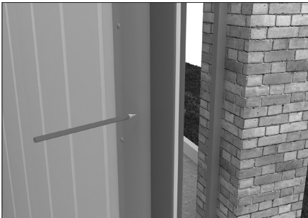
Разметьте отверстия для установки ручки.
