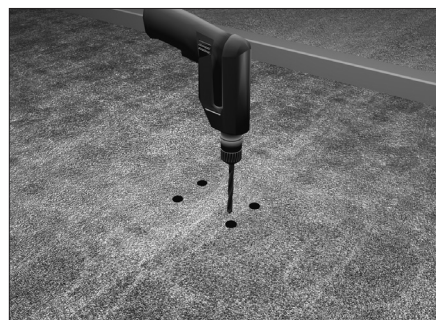
Просверлите 4 отверстия \varnothing 13 в дорожном покрытии.
