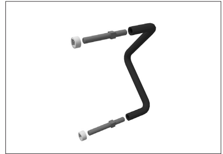
На квадратную часть винта наденьте гайку.
