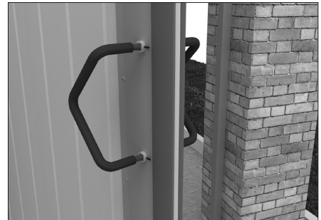
Вставьте винты с ручкой в отверстия в полотне распашных ворот. К винтам пристыкуйте вторую ручку.
